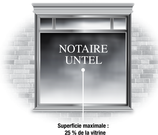
CROQUIS 6 – ENSEIGNE INSTALLÉE DANS UNE VITRINE
