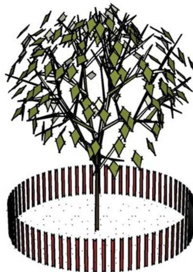
Pose d'une clôture sur le périmètre de la projection verticale de la cime des arbres au sol.
