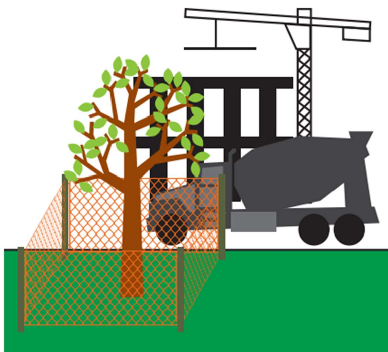
Figure 2 – Clôture de protection
