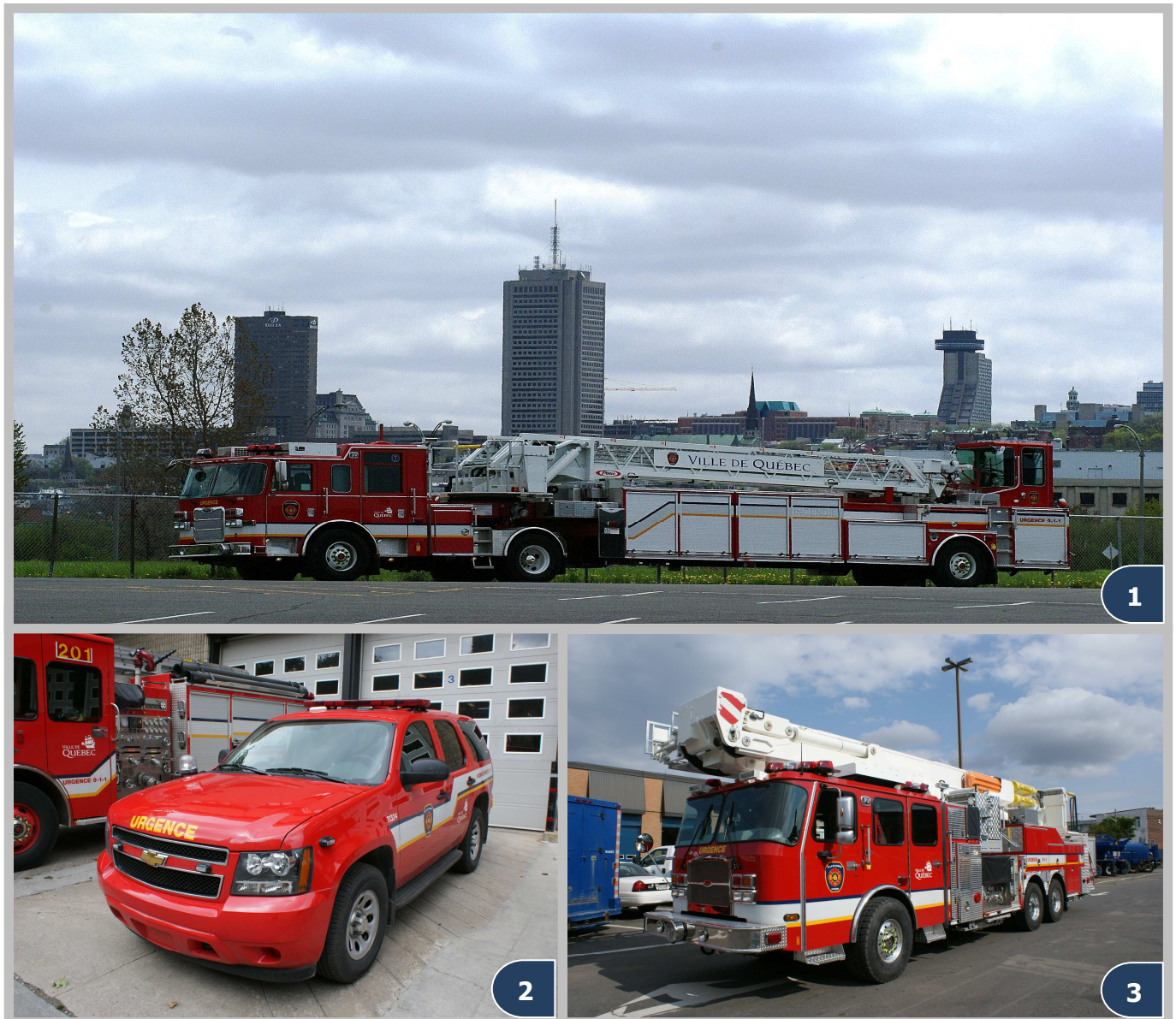
1) Camion échelle 100 pieds à timonier (caserne 1). 2) Véhicule du chef de peloton (TAHOE). 3) Pompe-échelle plateforme bronto de 134 pieds (caserne 9).
