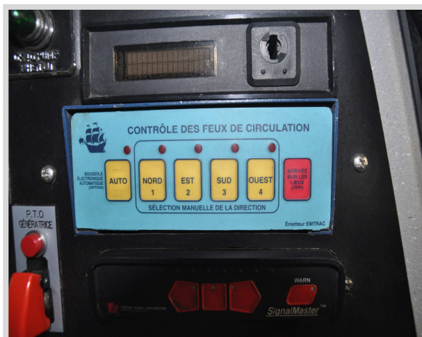
GPS et module de contrôle des feux de circulation installés dans les véhicules d'intervention
