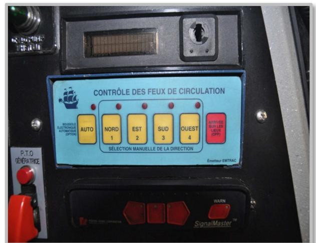
GPS et module de contrôle des feux de circulation installés dans les véhicules d'intervention.
