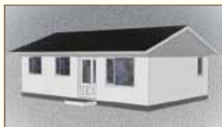
Ligne faîtière parallèle à la rue
