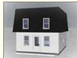
Imitation du toit mansardé
