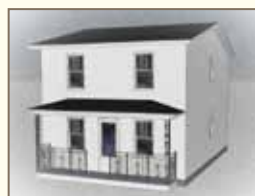
Ligne faîtière parallèle à la rue
