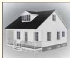
Ligne faîtière parallèle à la rue
