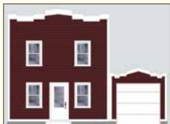
Ajout d'un garage dont le revêtement est semblable à celui de la maison
