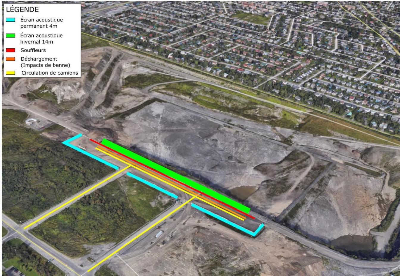
Figure 19 : Écrans acoustiques et équipements en opération déneigement pour la période hivernale
