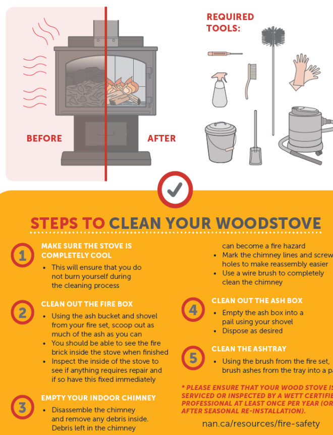
Figure 10. Guide étape par étape pour nettoyer un poêle à bois (NAN, 2021)
