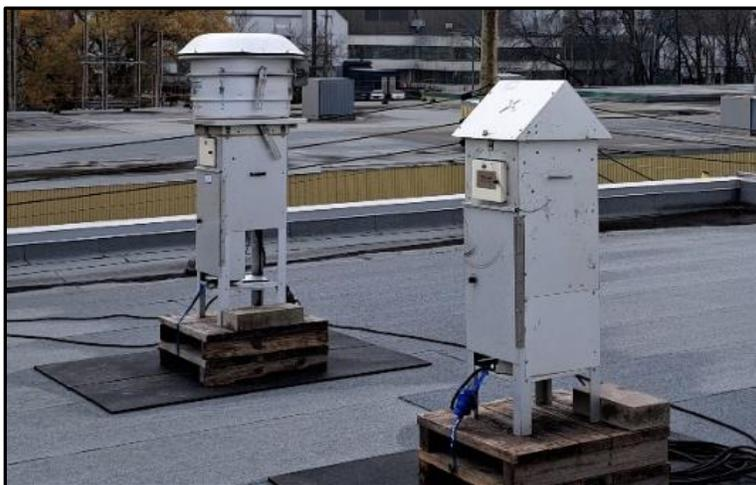
**Figure B- 1 Échantillonneurs à grand débit — PM<sub>10</sub> (tête ronde), PST (tête triangulaire)**
