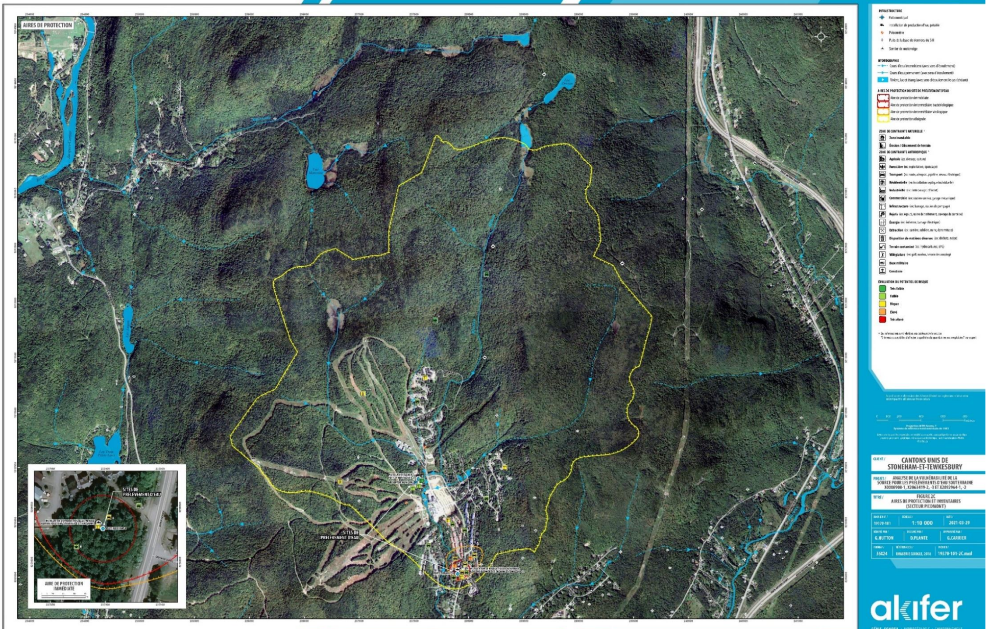
Figure 25. Aires de protection immédiate, intermédiaires (bactériologique et virologique) et éloignée de la source d'eau du secteur Piedmont de la Municipalité des cantons unis de Stoneham-et-Tewkesbury (Source : [1] Akifer, 2021)
