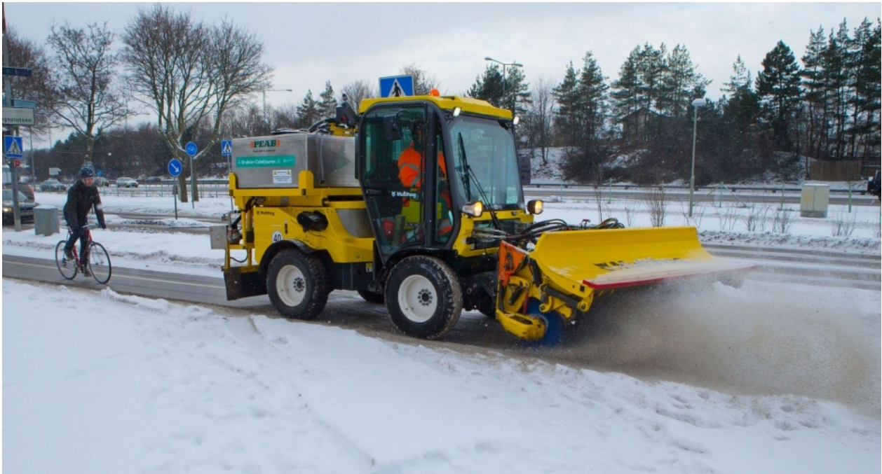
Figure 24. Tracteur équipé d'un module de déblaiement balai-charrue combiné
