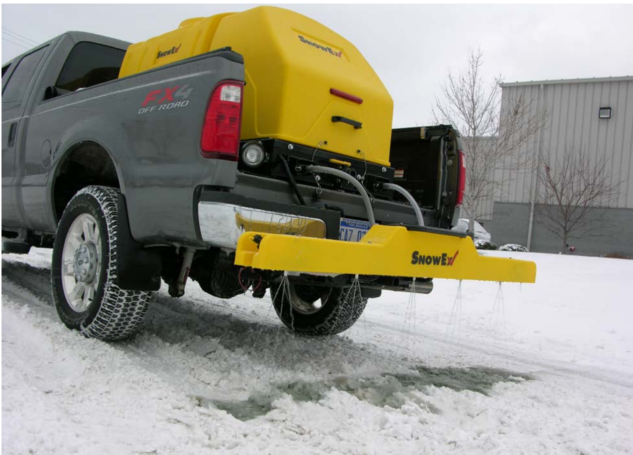
Figure 25. Réservoir et pulvérisateur de saumure monté sur une camionnette
