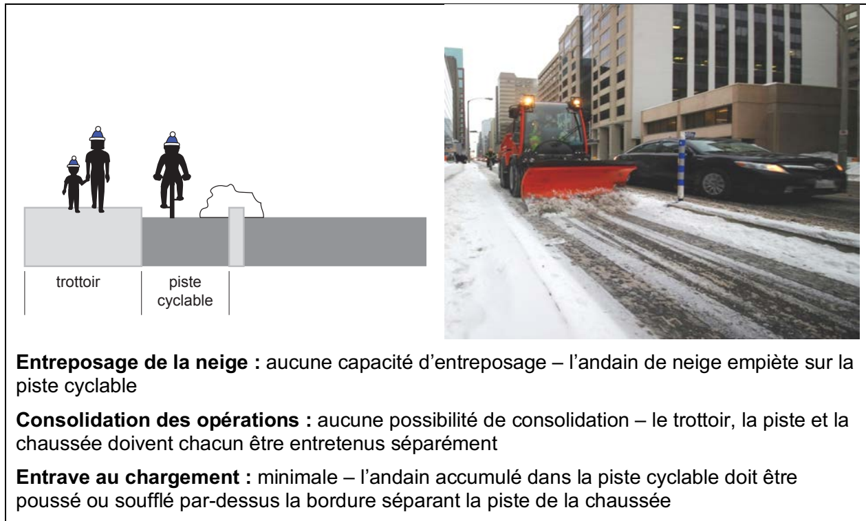
Figure 12. Trottoir-piste niveau chaussée
