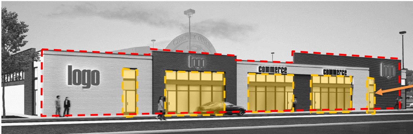
30 % de la superficie de la façade doit être vitrée
