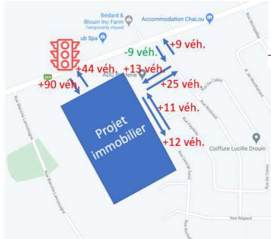
Débits de circulation additionnels sur les rues du quartier résidentiel à l'HPPM
