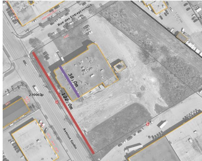
Largeur d'un bâtiment doit être  $\geq 60\%$  de la largeur d'un lot.
