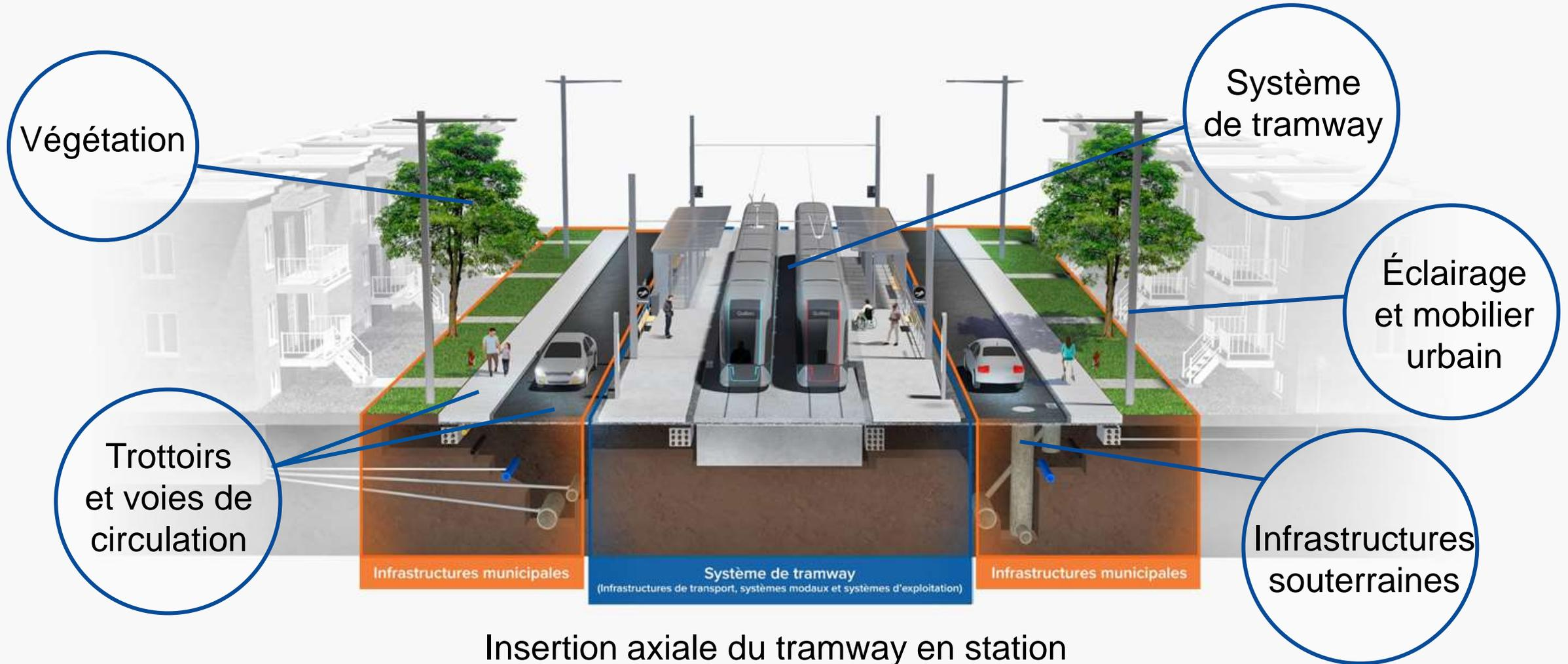
Insertion axiale du tramway en station
