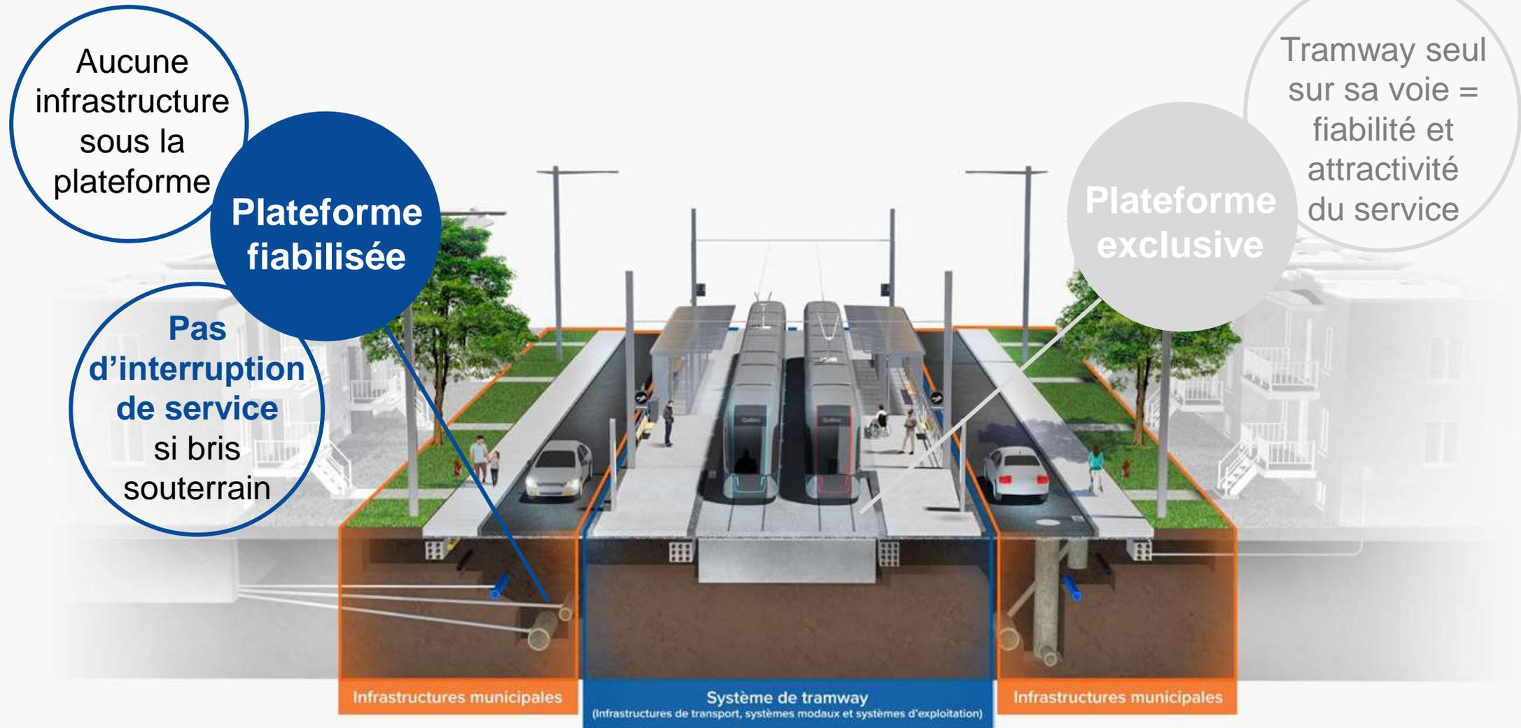
Insertion axiale du tramway en station
