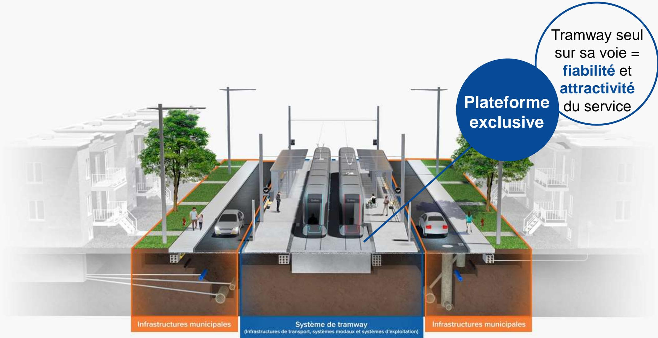
Insertion axiale du tramway en station
