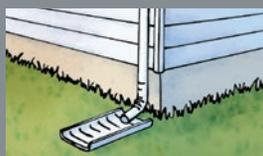
Cette solution permet d'éviter l'accumulation d'eau près de la fondation et dans le drain de fondation. L'eau doit être dirigée ou déversée à plus de 2 m de la maison.
