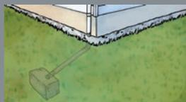
Le puits percolant facilitera l'absorption de l'eau dans le sol.
