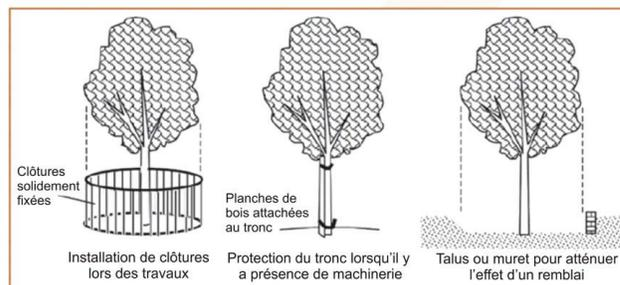
**Figure 2.** Mécanismes de protection des arbres (APEL, 2008)
