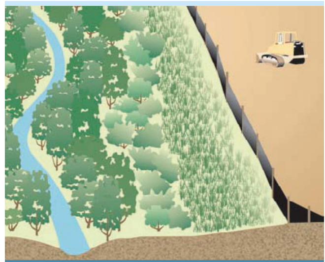
Figure 3. Délimitation d'une zone de travail avec une barrière à sédiments (EPA, 2007)
