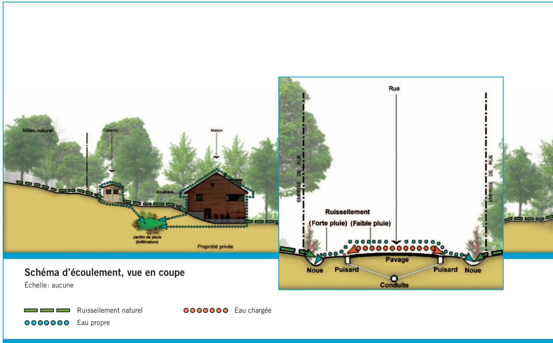
**Principe de séparation des eaux propres des eaux chargées**
