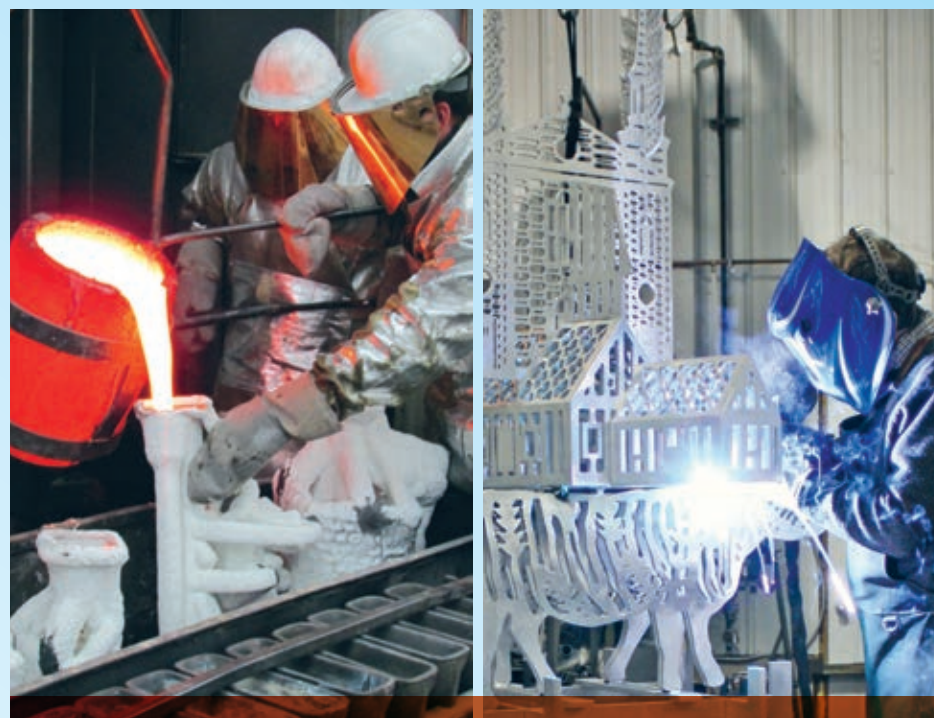
La réalisation d'une œuvre d'art fait appel à des techniques de toutes sortes. À gauche : La coulée du métal en fusion à l'Atelier du bronze d'Inverness. À droite : Soudure de la dernière pièce du repère commémoratif de Charlesbourg à la Forge ornementale Lapointe de Québec. Photos : Ville de Québec.
